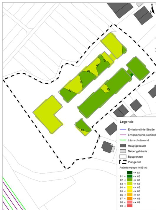
Abb.1 Außenlärmpegel nach DIN 4109-2:2018 Nacht, 2. Obergeschoss
