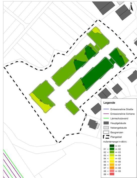
Abb. 2 Außenlärmpegel nach DIN 4109-2:2018 Nacht 1. Obergeschoss
