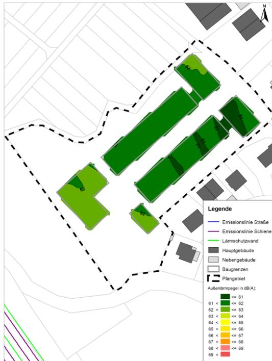
Abb. 1 Außenlärmpegel nach DIN 4109-2:2018 Nacht Erdgeschoss
