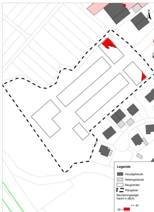
Abb. 4 Fassaden mit Ausschluss öffentlicher Fenster
